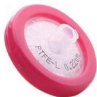
Adecuados para la preparación de muestras en aplicaciones de HPLC. Membrana fabricada en Politetrafluoroetileno (PTFE) hidrofóbico, resistente a casi todos los disolventes orgánicos agresivos, ácidos y bases. Gran resistencia térmica. Cuerpo de polipropileno (PP) de color fucsia. Diseñadas con conexiones FLL/MLS
