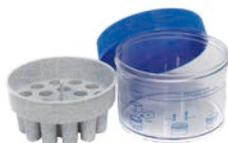
Diseñado para su uso tubos criogénico, los contenedores de congelación proporcionan una refrigeración simple de muestras a la tasa óptima para preservar células. Fabricados con un recipiente de policarbonato, cierre y soporte de tubos de HDPE, e inserto de espuma, ofrecen una tasa de enfriamiento crítica y repetible de -1 °C por minuto, necesaria para una criopreservación y recuperación celular exitosa. Incluye insertos para tubos de 1.0, 1.8 y 2.0 ml, tienen capacidad para 18 tubos
