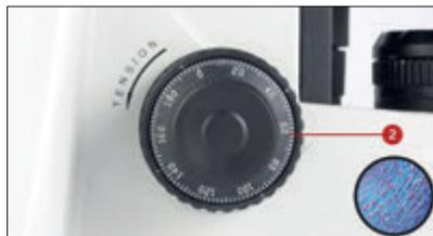
2 - Enfoque utilizando los tornillos de ajuste macro y/o micrométricos hasta que la imagen sea nítida.
