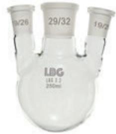
**MATRAZ ESFÉRICO ESMERILADO CON 3 BOCAS INCLINADAS**
