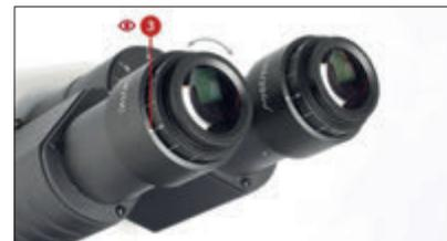
3 - Mire a través del ocular de la izquierda con el ojo izquierdo. Utilice el anillo de ajuste de dioptrías para enfocar la muestra hasta que la imagen sea nítida.
