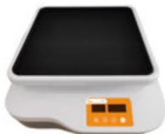
Dos pantallas LED que muestran tiempo y velocidad. Función temporizador (1 min - 19 h 59 min). Velocidad regulable entre 10 y 80 rpm. Ángulo de movimiento oscilante de 7°. Dimensiones plataforma: 268 x 268 mm. Capacidad de carga de 2 kg. Motor sin escobillas, libre de mantenimiento. Dimensiones (L x A x H): 294 x 348 x 123 mm. 200-240 V / 50-60 Hz. Grado de protección IP21. Garantía 2 años
