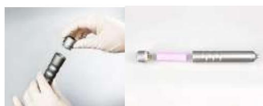
C) Sujete el cuerpo del homogeneizador con la mano e inserte la varilla de molienda del tamaño requerido en la unión del homogeneizador en la dirección indicada en la figura.
