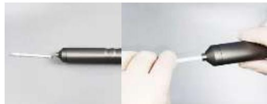
D) Inserte la varilla de molienda en el tubo de centrifugación que contiene la muestra y la solución de lisis (se recomienda que el volumen de la solución de lisis no supere los 150  $\mu$ l); presione el interruptor situado en la parte superior del homogeneizador para iniciar el funcionamiento. Para detener la operación, vuelva a presionar el interruptor.
