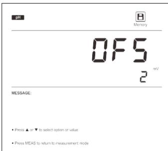
4.4 Presione la tecla ▼; el medidor mostrará el desfase del punto cero (por ejemplo, 2mV).
