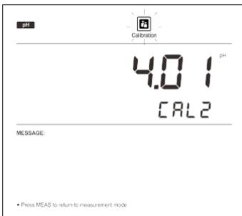
2.3 Enjuague el electrodo de pH con agua destilada y coloque el electrodo (y la sonda de temperatura) en la siguiente solución buffer. El medidor reconocerá automáticamente la solución de calibración (por ejemplo, pH4.01) y comenzará la calibración; el icono de Calibración parpadeará continuamente.
