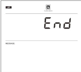
1.4 Espere a que la lectura se estabilice; el medidor mostrará automáticamente END y regresará al modo de medición. La calibración está completa.
