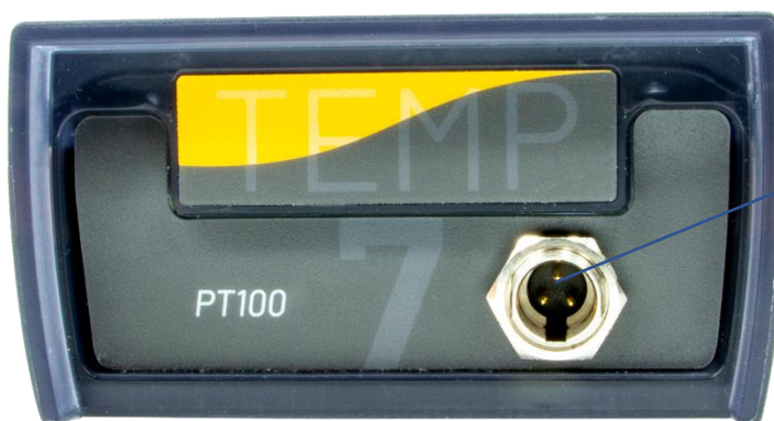
Temp7 PT100 Vio panel superior
